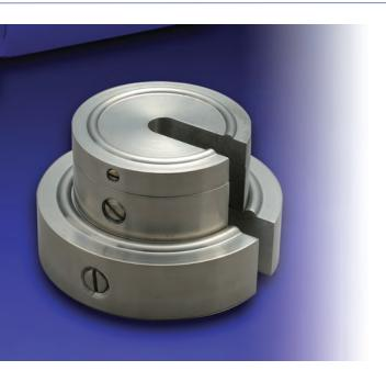
増おもり型分銅は、吊り下げ式はかりの質量測定の校正に使います。 ズレ防止の段・溝付きで安定感があり、複数積み重ねることがで きます。
