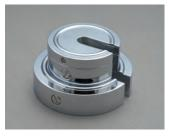
材 質: 黄銅クロムメッキ 密 度: JIS B 7609: 2008 11項に適合
