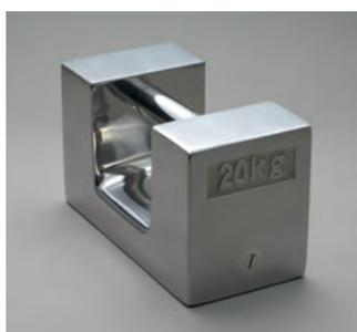
材質：鑄造用ステンレス鋼
